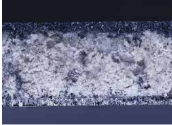
全固体電池の断面（マイクロスコープ観察）
