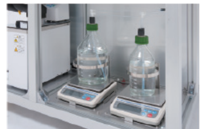
計量部（置換液 3000mL、原液 1000mL）
